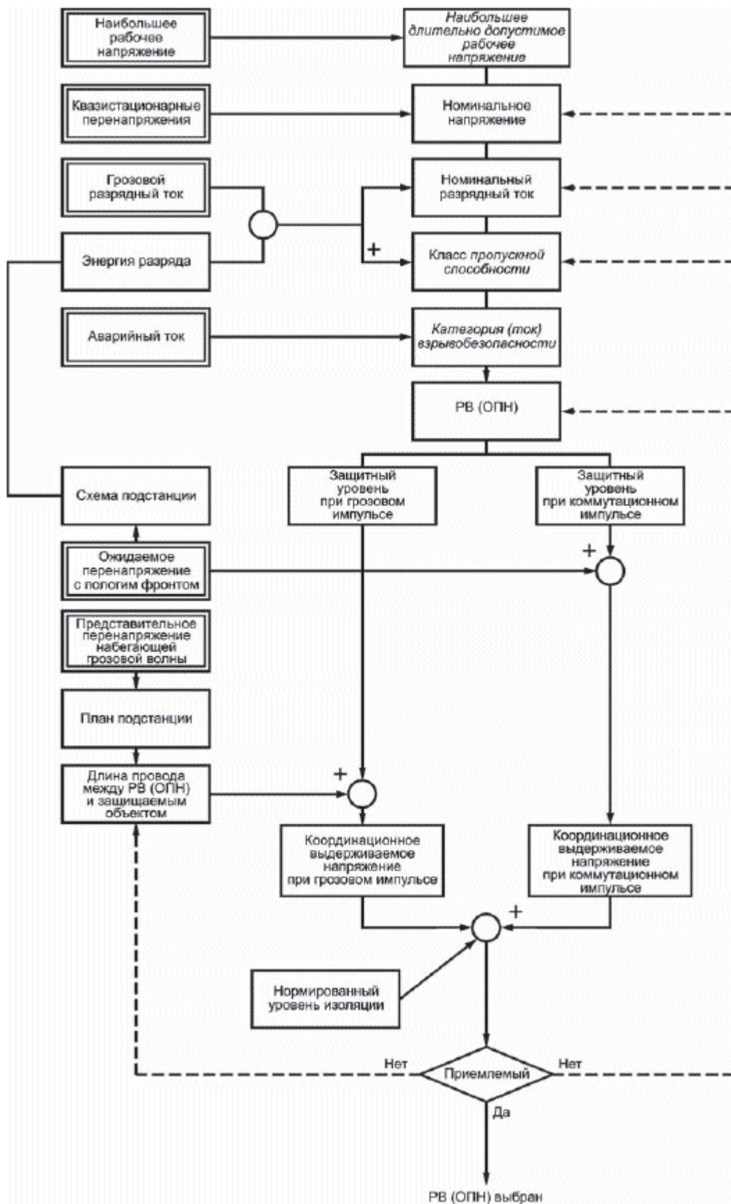
Рисунок 1 - Структурная схема выбора РВ (ОПН)
