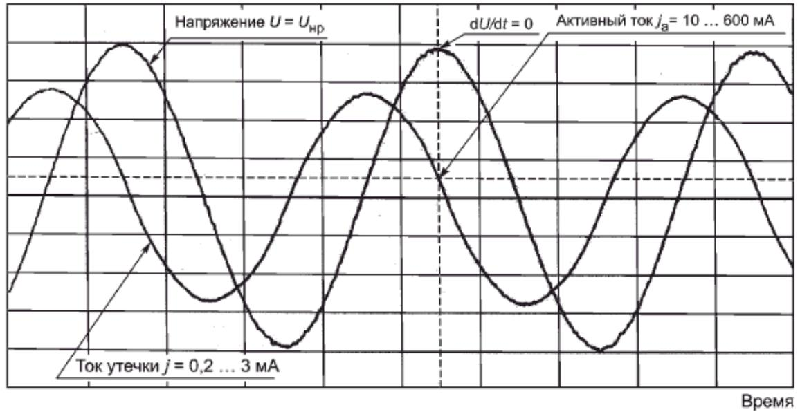
Рисунок 3 - Типичный ток утечки нелинейного металлооксидного резистора в лабораторных условиях
