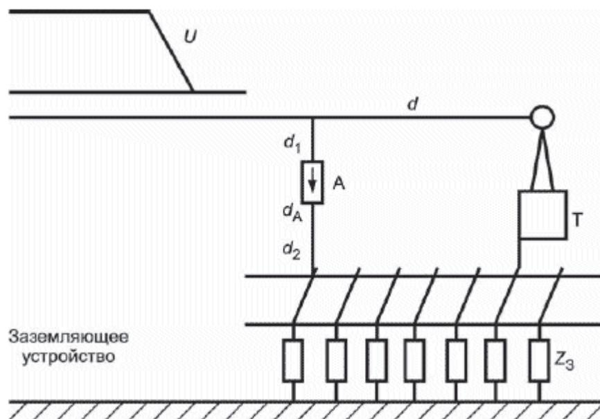
Рисунок 2б - Установки с контуром заземления (подстанции)
