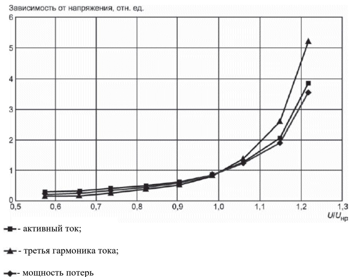
Рисунок 6 - Типичная нормализованная зависимость от напряжения при температуре +20 °С
