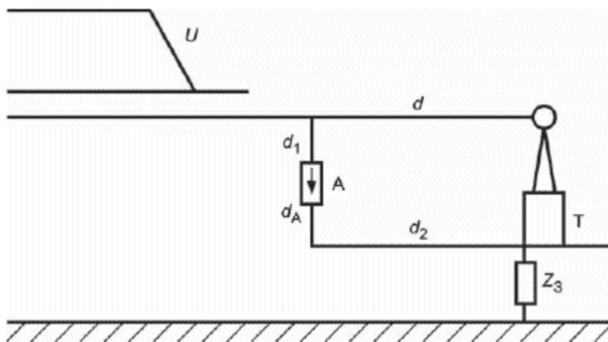
Рисунок 2а - Установки без контура заземления (распределительные сети)
