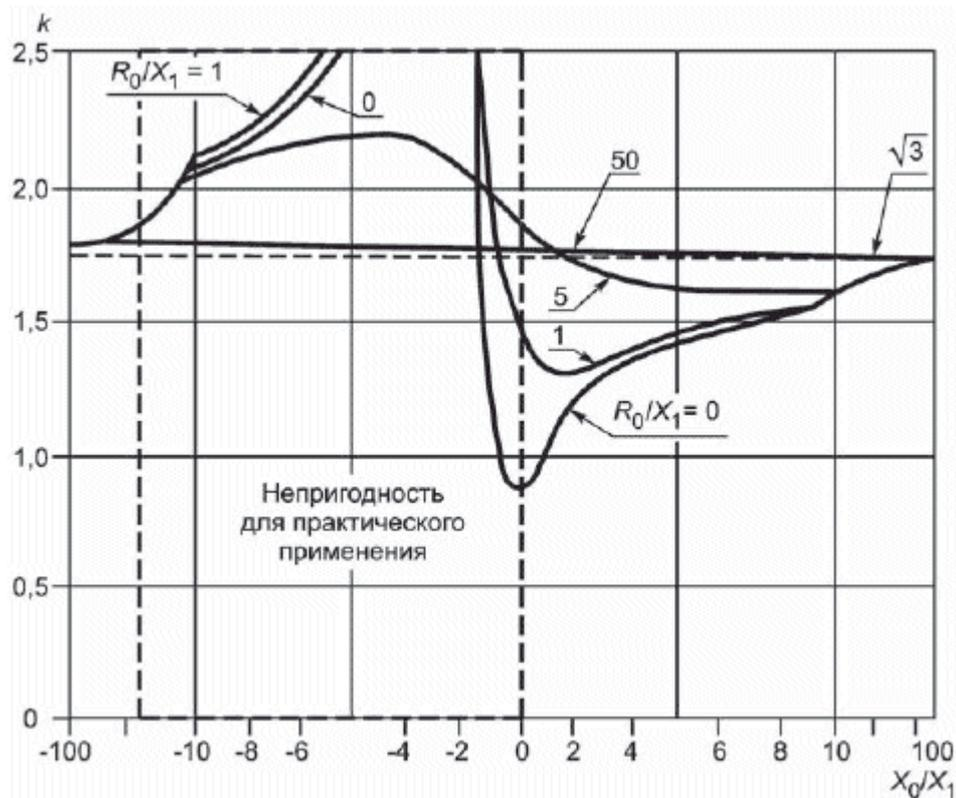
Рисунок А.1 - Коэффициент замыкания на землю  $k$  на основе для  $X_0 / X_1$ ,
