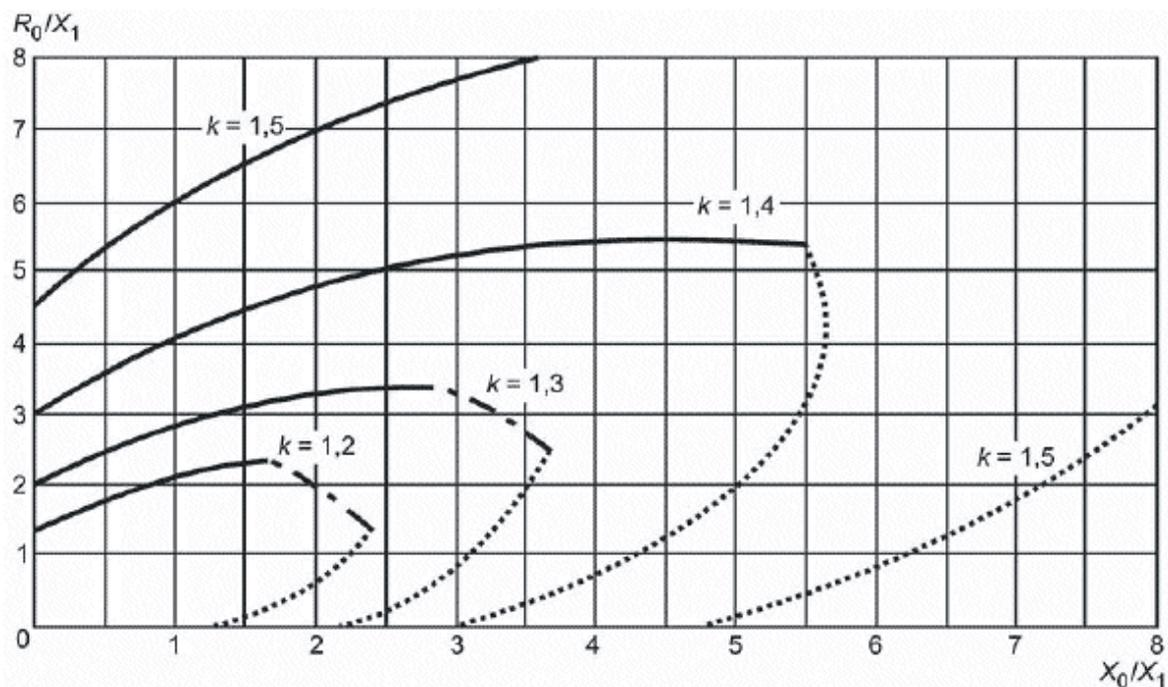
Рисунок А.4 - Соотношение между  $R_0 / X_1$  и  $X_0 / X_1$  для постоянных значений коэффициента замыкания на землю  $k$ , где  $R_1 = X_1$
