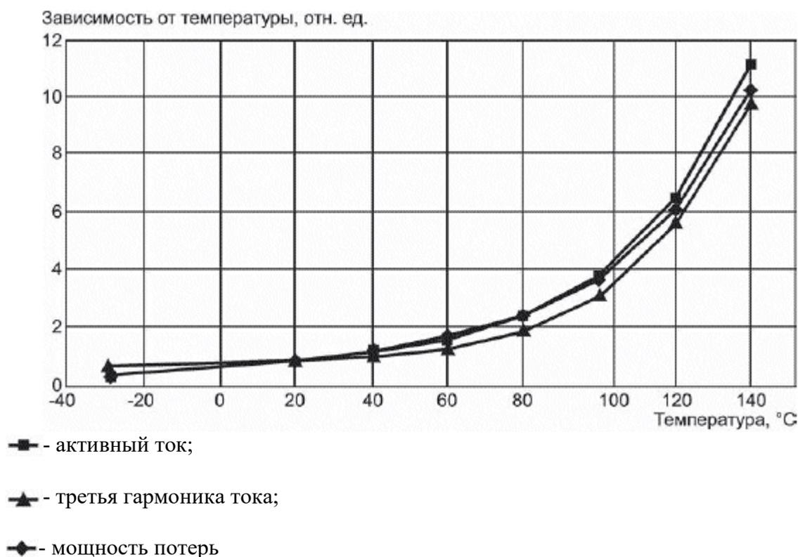
Рисунок 7 - Типичная нормализованная зависимость от температуры при наибольшем длительно допустимом рабочем напряжении  $U_{нр}$
