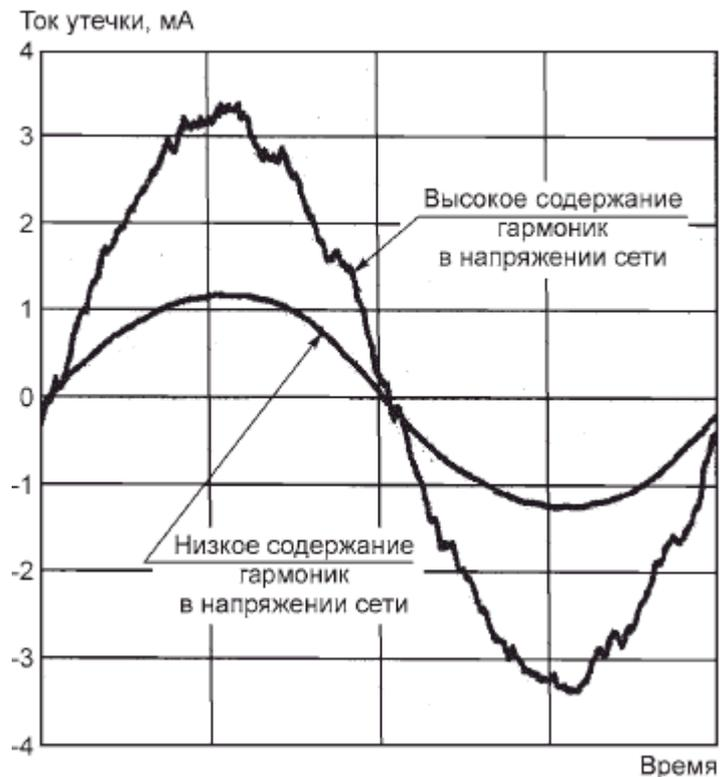
Рисунок 4 - Типичный ток утечки ОПН в условиях эксплуатации
