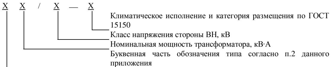
Для автотрансформаторов при классах напряжения стороны СН или НН 110 кВ и выше после класса напряжения стороны ВН через черту дроби указывают класс напряжения стороны СН или НН.
