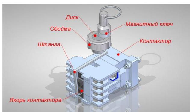
На редукторе установлена электромагнитная блокировка, которая устойчиво работает даже при снижении напряжения питания до 150 В. Все детали блокировки выполнены из нержавеющей стали. При отсутствии питания для разблокирования устройства предусмотрен магнитный ключ. При одетой рукоятке на вал ручного дублера блокируется работа от электрических аппаратов.
