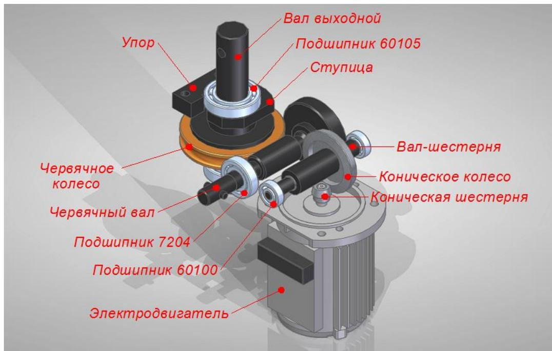
Выходной конец вала редуктора имеет уплотнение в виде круглого кольца. Редуктор установлен в шкафу таким образом, что после монтажа на разъединитель редуктор является несущей частью, а шкаф закреплен на редукторе при помощи шпилек, которые используются в качестве крепления привода при монтаже на месте эксплуатации. Шпильки с наружной поверхности шкафа имеют уплотнительные шайбы и гайки для крепления привода.
