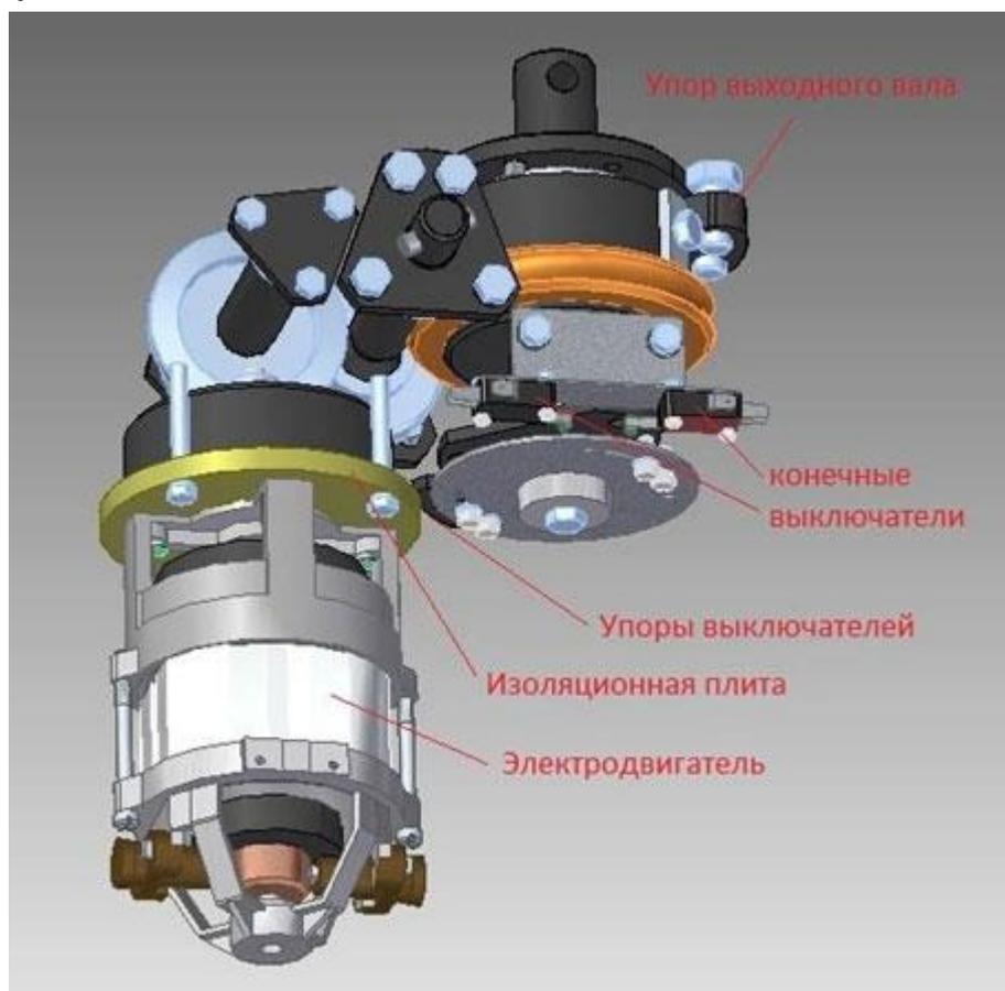
Статор электродвигателя изолирован от корпуса редуктора посредством промежуточной изоляционной плиты, а ротор соединен с конической шестерней через изоляционную втулку.
